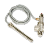
Zawór bezpieczeństwa STS 20 wymagany przy opalaniu peletem lub biomasą w kotłach z palnikiem retortowym/rynnowym
